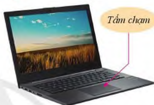
Hình 2. Tấm chạm (tấm cảm ứng) trên máy tính xách tay
